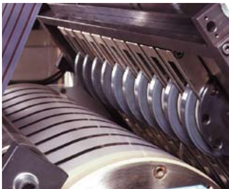
Individuelle Prägeradeinstellung Individual stamping wheel adjustment
